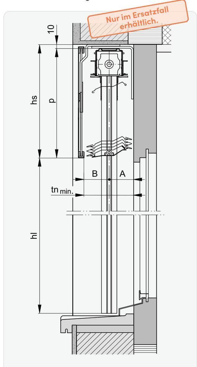
Horizontalschnitt: Führungsschiene Fix-L
