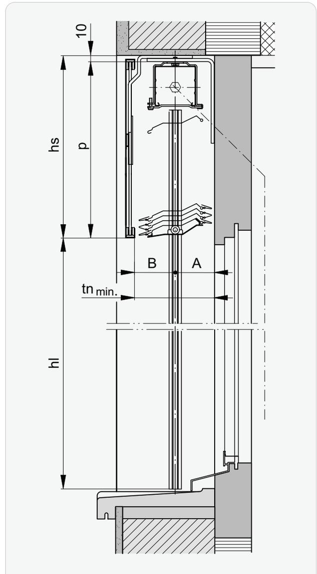
Horizontalschnitt: Führungsschiene Fix
